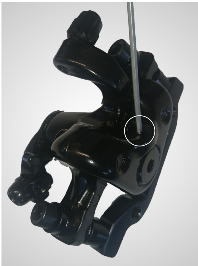
Fig. 15: Løsning af 2 mm skruestik
