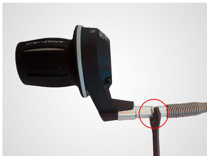
Fig. 17: Justering af grebshift-skifter
