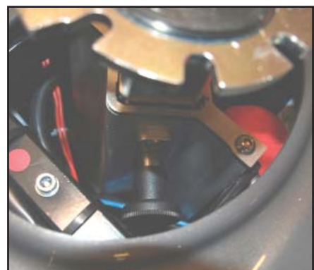
Udløseren trukket ud. Drej rundt igen, for at få den til at "hoppe" ind igen.
