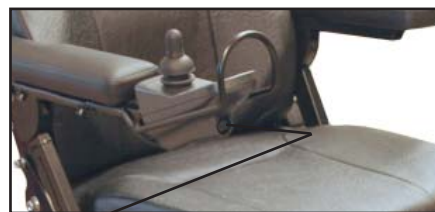
Ladestik forbindes til 3-polet stik på undersiden af joysticket.
