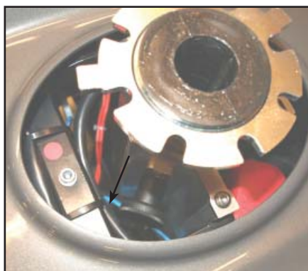
Træk ud i udløseren, og drej rundt. Så holder den sig ude. Nu kan sæderøret løftes eller sænkes til ønsket højde.
