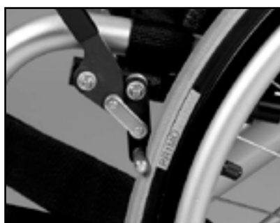
Fig. 44 Bremsen trykker korrekt på dækket
