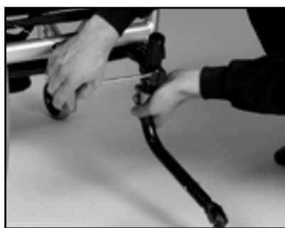
Fig. 42 Juster og genmonter bolte og møtrikker
