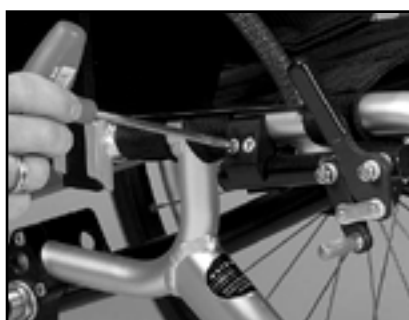
Fig. 43 Løsn boltene i beslaget
