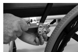
Bill. 11: Montering af bremsesystem på rammen.
