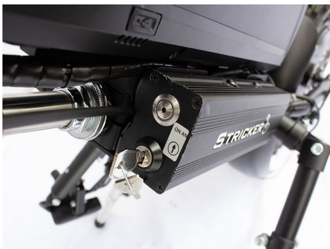
Fig. 11: Nøglekontakt på batteri og kontrol
