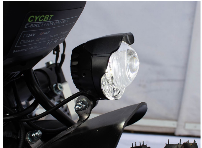
Fig. 17: Justering af lampens hældning med integreret horn
