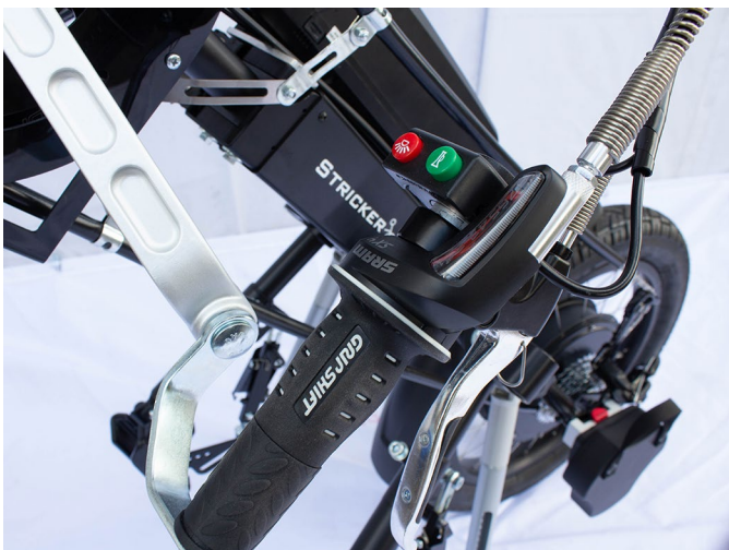
Fig. 19: Bremsehåndtag med bremsekontakt og igangsætning af rekuperation (afbryderkontakt er kun tilsluttet højre bremsehåndtag).
