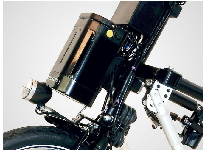
Fig. 20: Montering af batteriet
