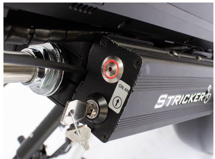
Fig. 18: Bakgearlyset på betjeningsenheden lyser, når bakgearet er aktiveret
