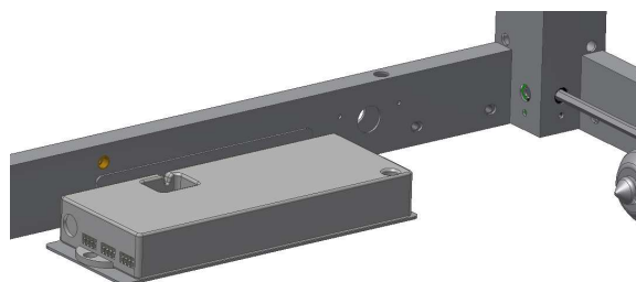
6.1.4 Herefter monteres de to forsarge. Det er meget vigtigt at både side- og forsarg bliver trykket hårdt ind mod benet inden sargene bliver efterspændt. Sørg for at spænde boltene hårdt med medfølgende nøgle.
