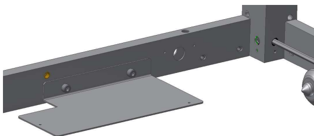
6.1.3 Kontroler at højden (L) på alle fire ben er ens. Kan justeres på sekskant-aksel med medfølgende fastnøgle. Sidesarge placeres på et plant underlag hvorefter benene monteres herpå. Se mærkeseddel på ben.
