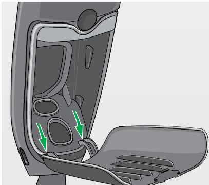
Billede 5.1 Isætning af filterafdækning
