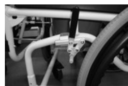
Billede 11: Montering af bremses på rammen.
