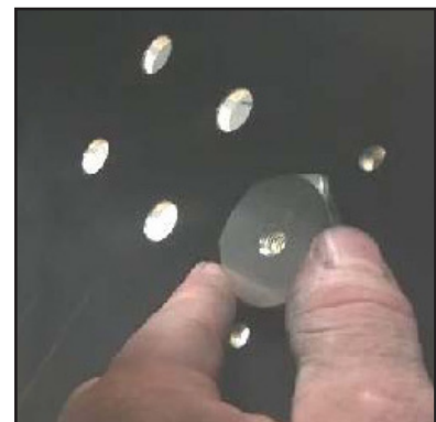
Møtrikkerne placeres i de forborede huller.
