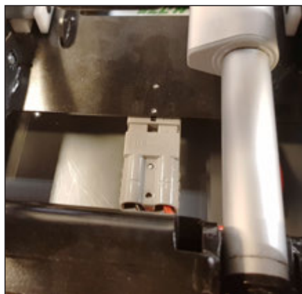
Forbind stikket igen ved at styre/trykke med det røde håndtag.
