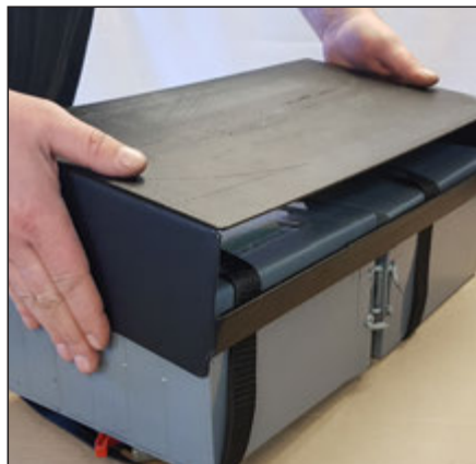
Læg batterikassen over og vil den rundt med batterierne.
