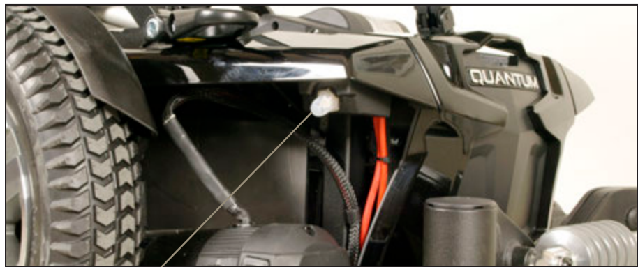
Her sidder automatsikringen.
