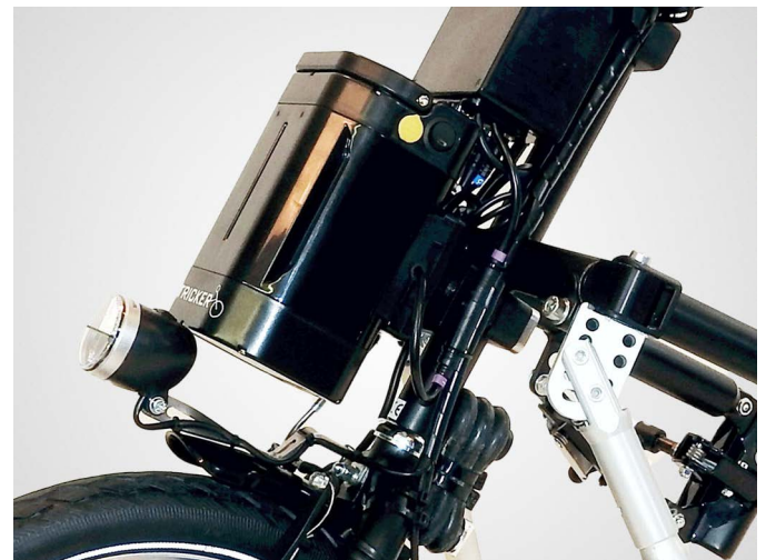
Fig. 32: Befestigung 36V Batterie
