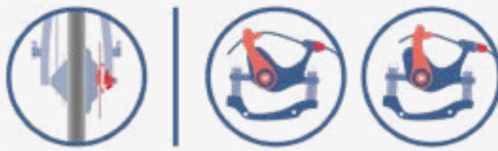
Abb. 75: Justering af justeringsskruen
