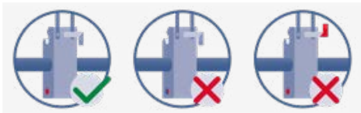
Abb. 43: Positivt og negativt eksempel: Bolt helt udstrakt og låsestift i indgreb
