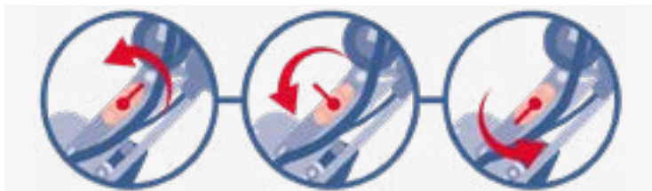
Abb. 107: Frigørelse af hagekontrollen
