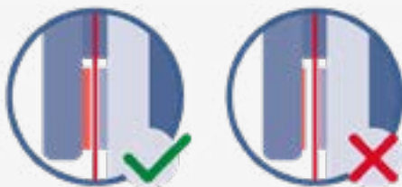
Abb. 79: Positivt og negativt eksempel på skivebremser
