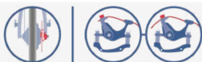
Abb. 76: Stram kabeltrækket igen
