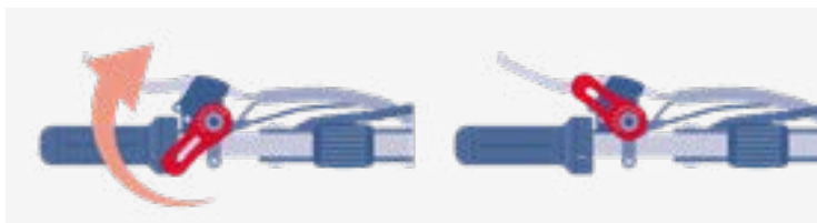
Abb. 44: Frigør centerlåsen ved hjælp af håndtaget på styret
