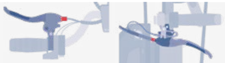
Abb. 81: Stram kablet på bremsegrebet
