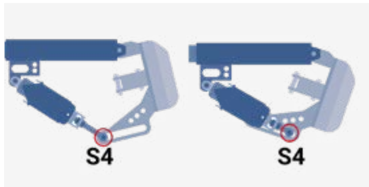
Abb. 21: Juster klemmens hældningsvinkel
