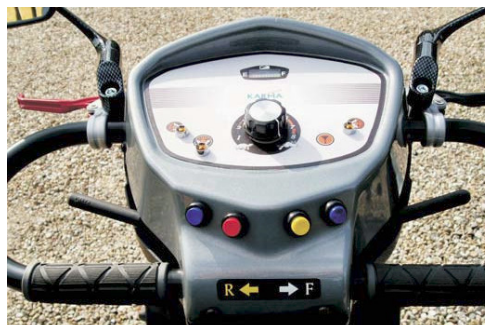
Overskueligt instrumentbord m/tryknap for lys, blinklys og horn.
