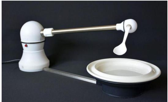
Den elektriske iEAT Spiserobot er batteridrevet og har to mulige indstillinger: Semi- eller fuldautomatisk styring.
