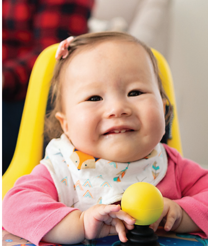
Det centermonterede joystick fremmer brugen af begge arme
