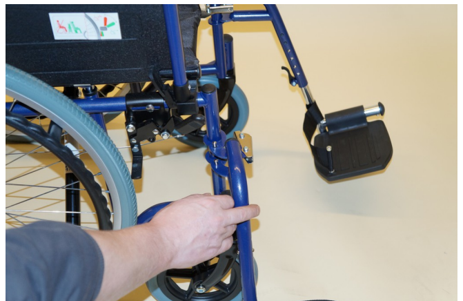
Benstøtte sættes på ved og dreje den 90 grader ud fra rammen og sætte den ned på de to blanke stifte
