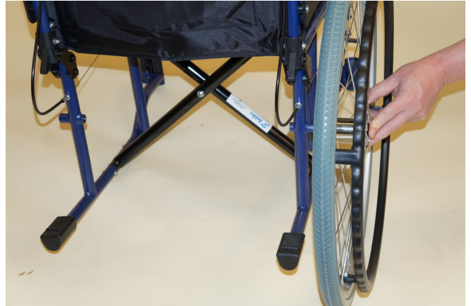
Aksel sættes gennem hjul og gennem rør i ramme
