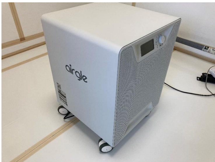
Figur 1: Testemne: Luftrenser "Airgle". Der er oplyst en "Tobacco Smoke"-CADR-værdi på 363 CFM (= 617 m 3 /time) på testemnet.
