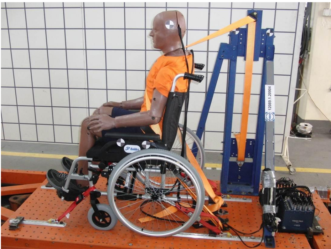
Fot. 1 Wózek wraz z systemem zamocowania przed próbą dynamiczną – przodem do kierunku jazdy. Pic.1 Wheelchair with tiedown system before dynamic test – in forward direction.
