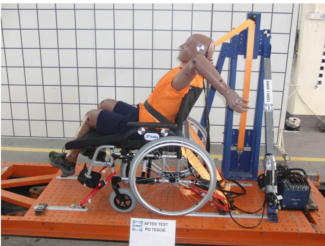
Fot. 2 Wózek wraz z systemem zamocowania po próbie dynamicznej – przodem do kierunku jazdy. Pic.2 Wheelchair with tiedown system after dynamic test – in forward direction.
