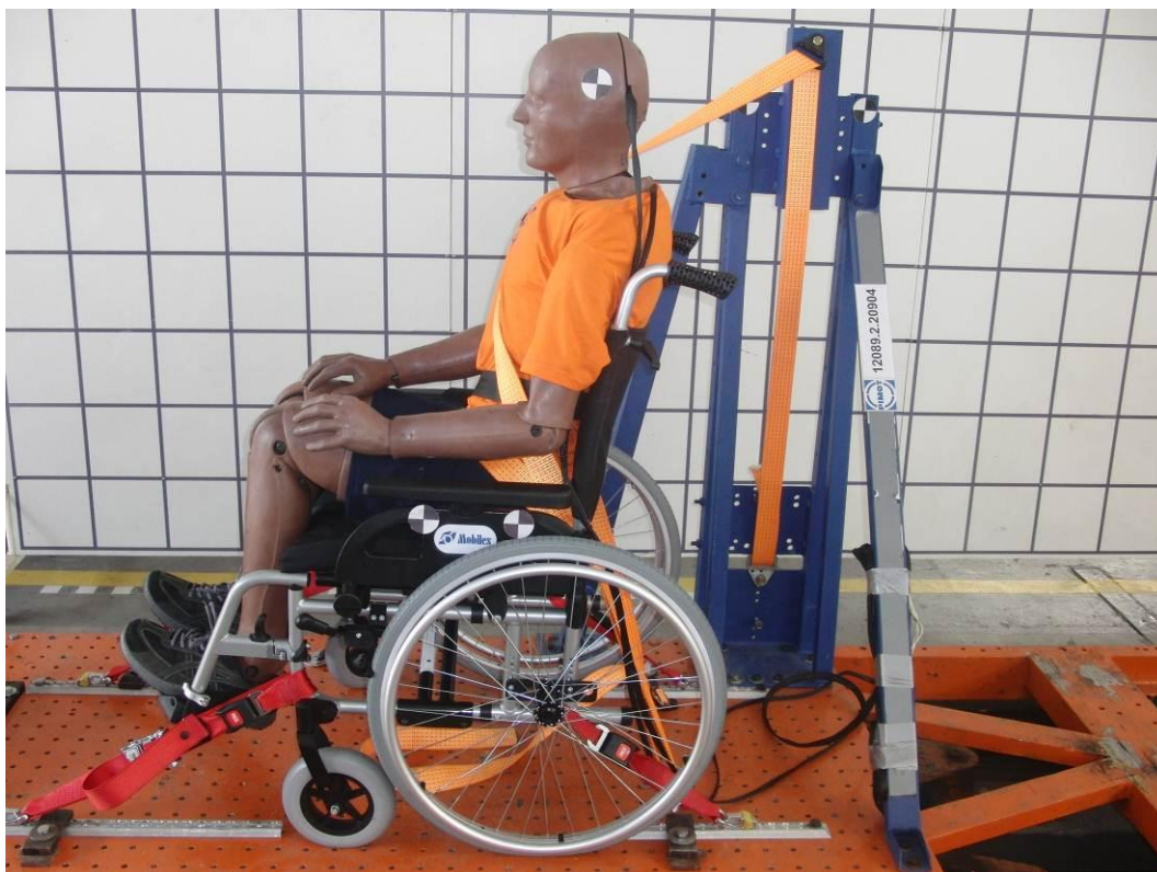
Fot. 3 Wózek wraz z systemem zamocowania przed próbą dynamiczną – tyłem do kierunku jazdy. Pic.3 Wheelchair with tiedown system before dynamic test – in rearward direction.
