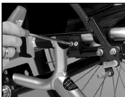
Fig. 35 Løsn boltene i beslaget
