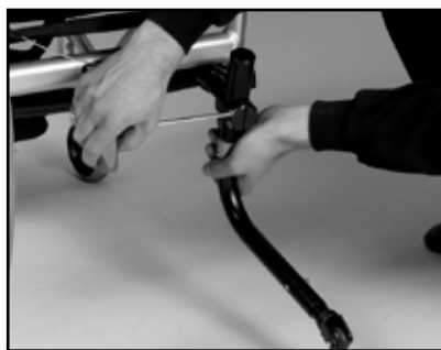
Fig. 34 Juster og genmonter bolte og møtrikker
