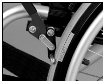
Fig. 36 Bremsen trykker korrekt på dækket
