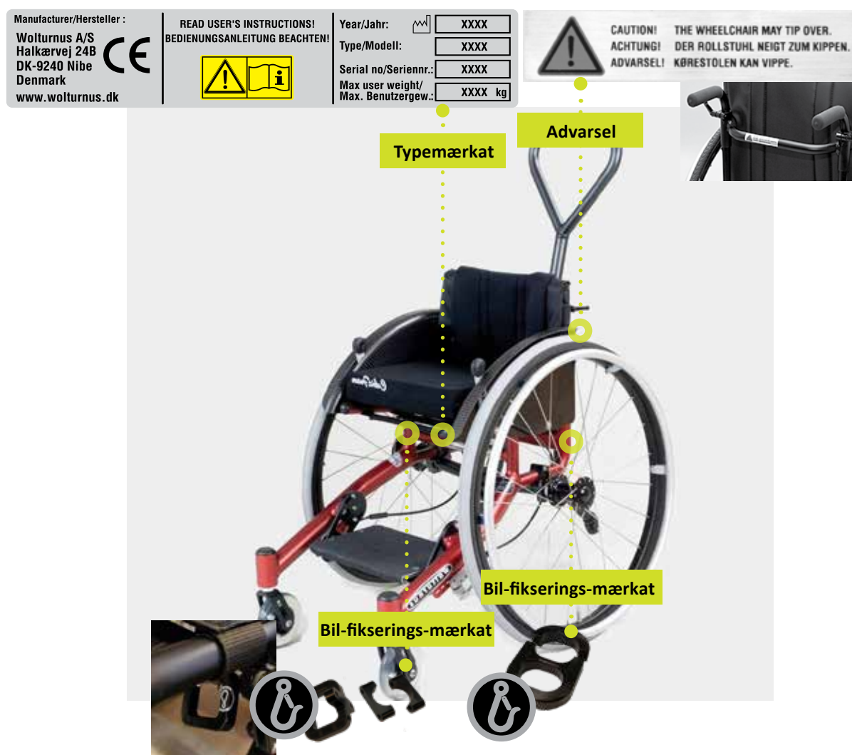
Fig. 1 Placering af typemærkat, anti-tip advarsel og fastgørelsespunkter
