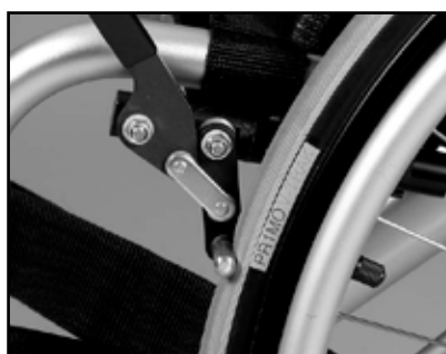
Fig. 44 Bremsen trykker korrekt på dækket
