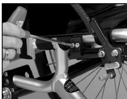
Fig. 43 Løsn boltene i beslaget
