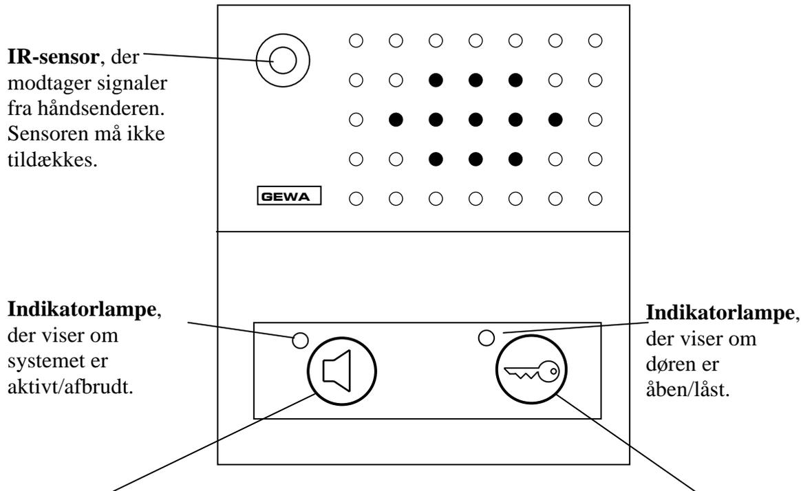
**IR-sensor**, der modtager signaler fra håndsenderen. Sensoren må ikke tildækkes.
