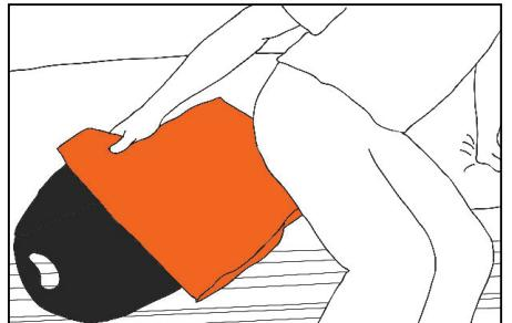
**DK** Til forflytning af bruger med bar hud anvendes Master Glide glidestykke. Burrebåndet på glidestykket åbnes og burrebåndsenderne føres ned i de to spor på Master Glide Flexi fra overfladen og ned
