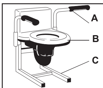
Skyllevask BDA 0891-04 A: Støtthåndtag 100837 B: Vask BDA0890-04 C: Støtteramme 100836
