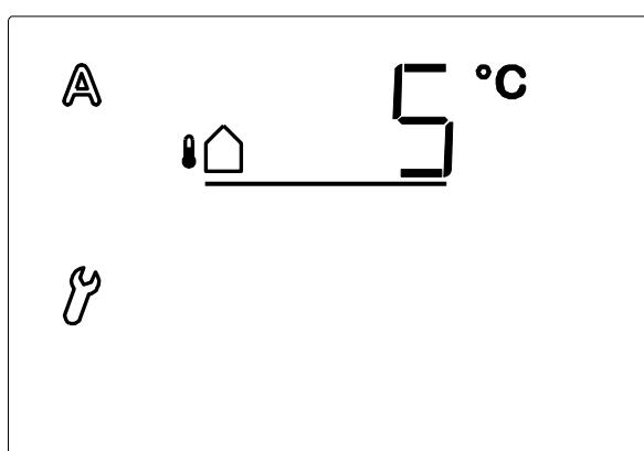
Hysteresen for udetemperatur-spærre er 2°C, dvs. åbning af vinduet gives først fri når udetemperaturen er mere en 2°C over den indstillede temperatur.
