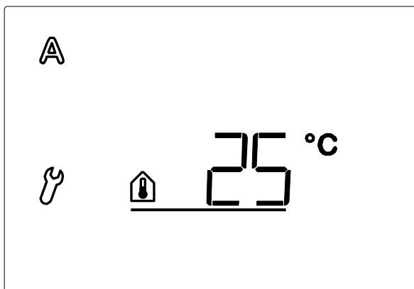
Der er en hysterese på 2°C på indetemperaturen, dvs. vinduet lukkes igen, så snart indetemperaturen falder med mere en 2°C under den indstillede temperatur.
