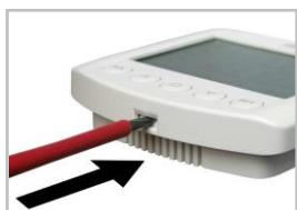
Der benyttes to standardbatterier 1,5 V eller 1,2 V af typen AA (Mignon/LR6). Kassen lukkes ved at hægte frontpladen med printet ind i den bageste del foroven. Låsen forneden skal trykkes i med et tydeligt "klik"
