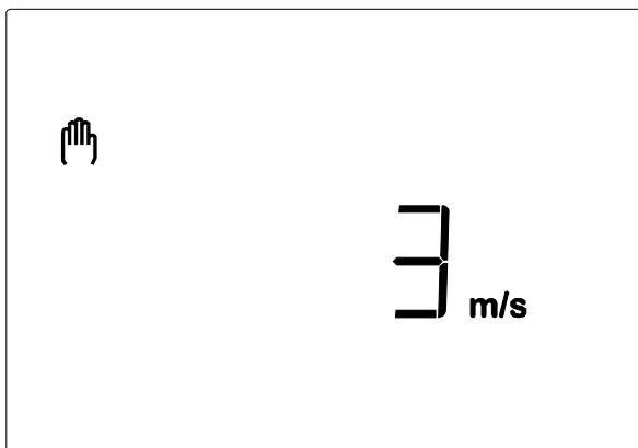
Bemærk: Vindhastigheden vises ikke korrekt i ca. 90 sekunder efter at spændingen er vendt tilbage til vejrstationen (fx efter strømsvig eller ved idrifttagning). Hvis vindalarmen er aktiveret, er den manuelle betjening derfor spærret i denne periode.
