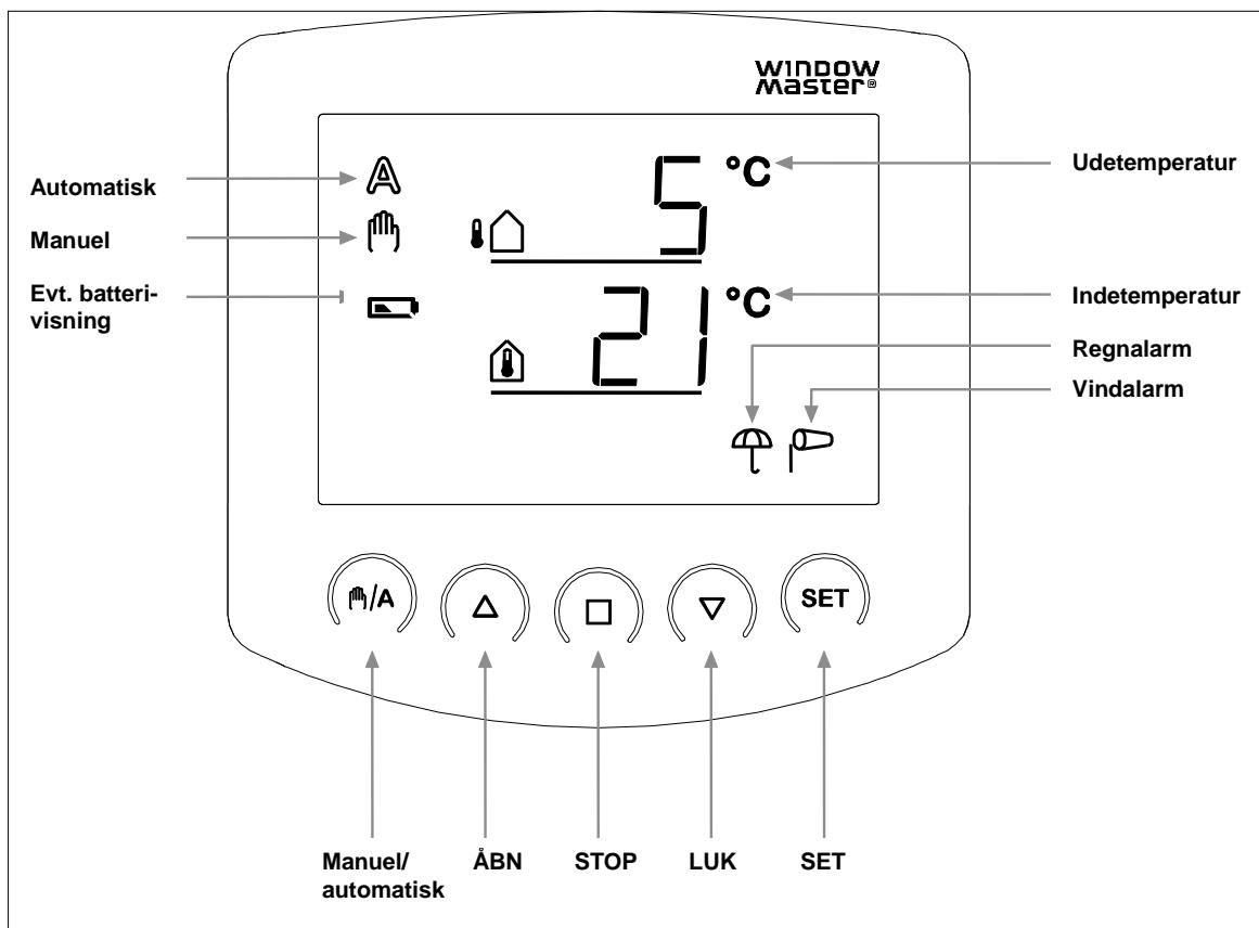
Betjeningspanelet viser styresignalene; ude- og indetemperatur samt en eventuel regn- eller vindalarm.
