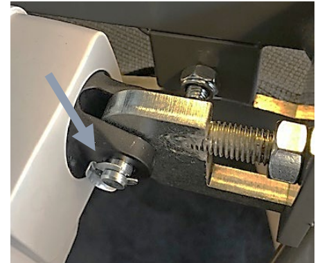
Bolt i den modsatte ende af benmotor
