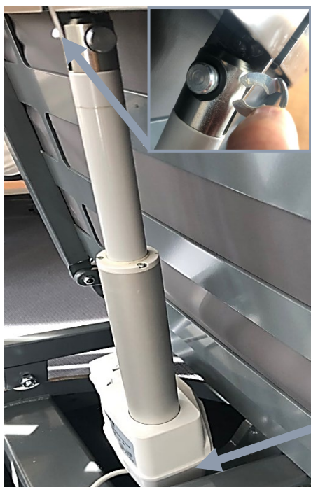
Placering af clips og bolt
