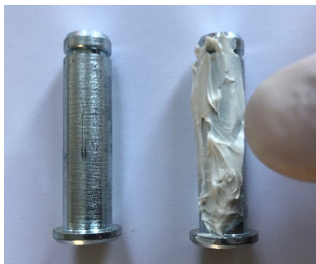
Påføring af fedt på bolt
