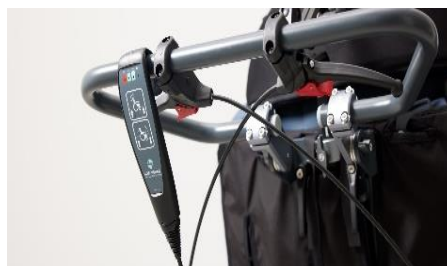
Bremsegrebene er monteret på skubbebøjlen.
