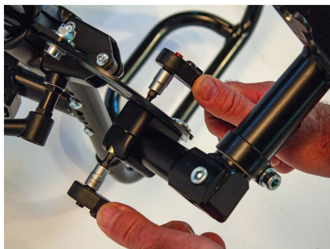
Fig. 15: Løsning af S5R og S5L
