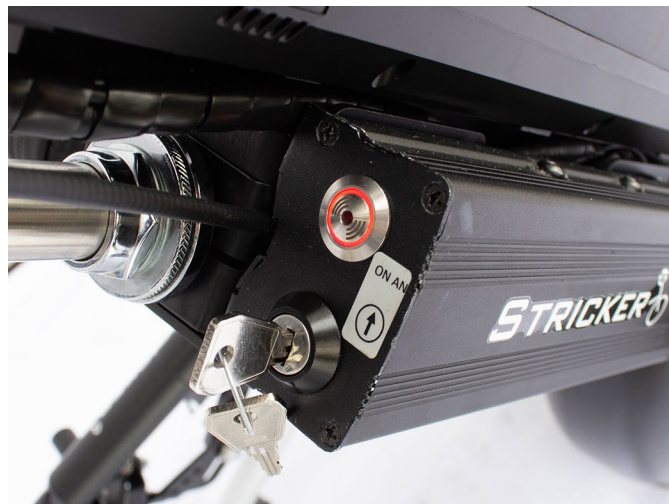
Fig. 41: Bakgearlyset på betjeningsenheden lyser, når bakgearet er aktiveret
