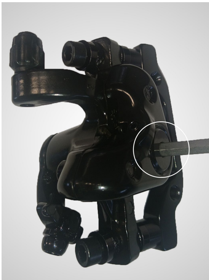
Fig. 48: Løsning af 5 mm bremseklodsindstillingen
