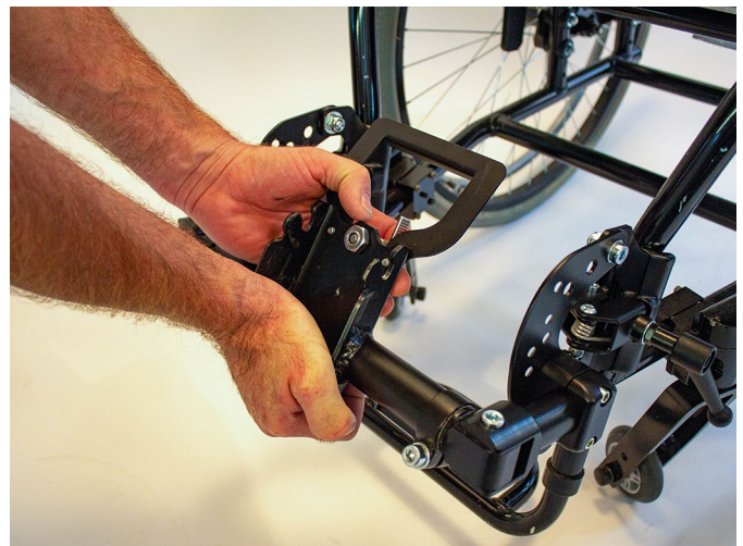
Fig. 18: Koblingsplade hælder for meget
