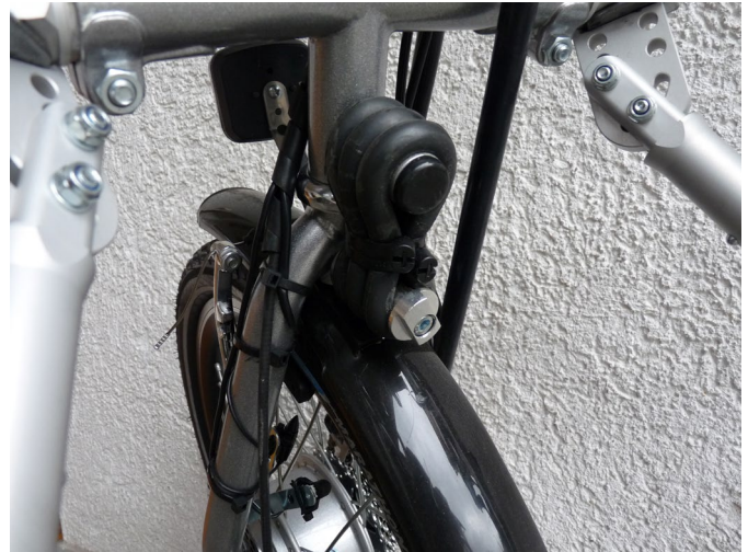
Fig. 43: Indstilling af styringsdæmper
