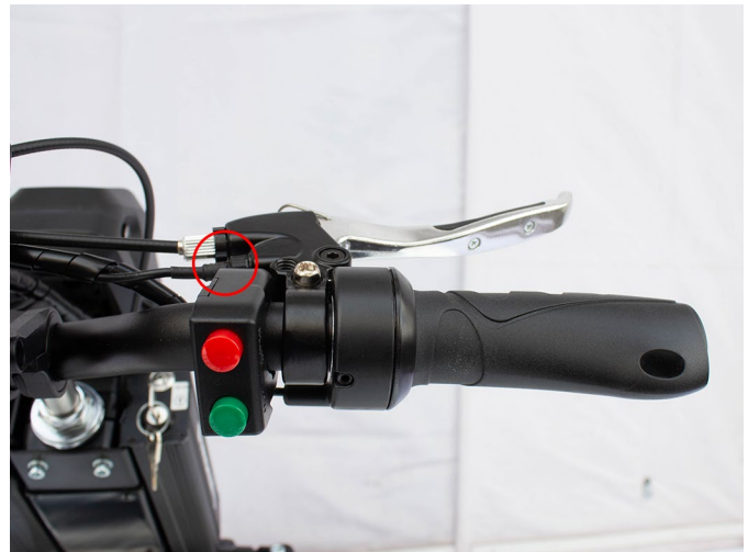
Fig. 42: Bremsehåndtag med bremsekontakt og igangsætning af rekuperation (afbryderkontakt er kun tilsluttet højre bremsehåndtag).
