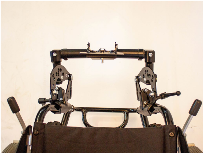
Fig. 16: Korrekt justeret ramme
