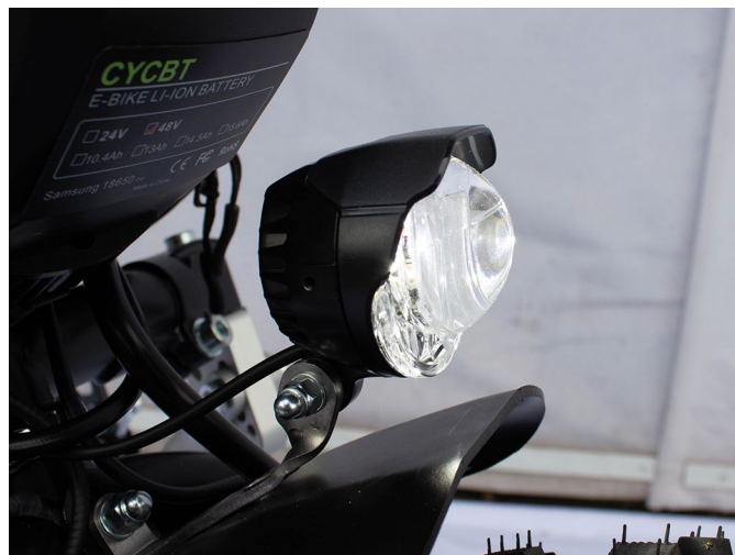
Fig. 40: Indstilling af lygtens hældning med integreret horn
