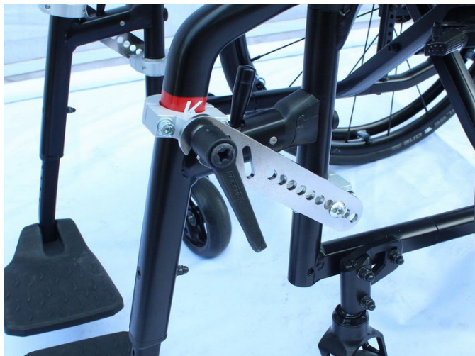
Fig. 5: Formonteringsfixet stabiliserer de svingbare fodstøtter og muliggør en stabil klemmeforbindelse.
