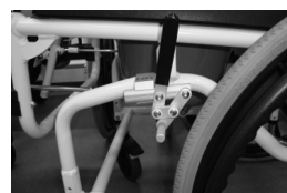
Billede 11: Montering af bremses på rammen.
