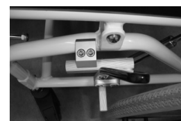
Billede 12: Kontroller om bremsesne griber fat i dækket på hjulet.
