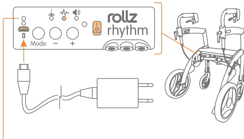
De module zal een rood licht weergeven wanneer deze aan het laden is, dit licht wordt groen wanneer deze volledig is opgeladen. Laad de module enkel op met een lader met een vermogen van 5V en 1A.
