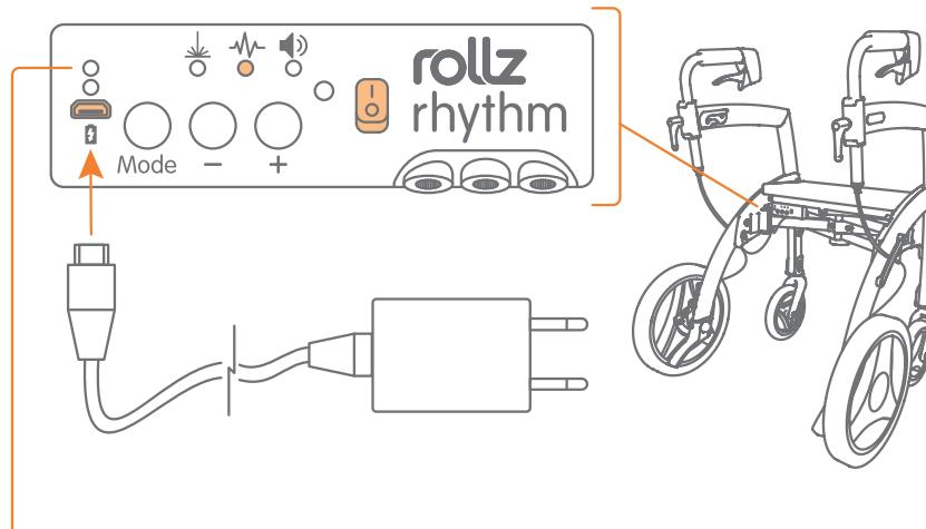
Das Modul zeigt ein rotes Licht an, wenn es aufgeladen wird. Diese Lampe wird grün, wenn es vollständig aufgeladen ist. Das Modul darf nur durch einen Adapter mit 5V oder 1A aufgeladen werden.
