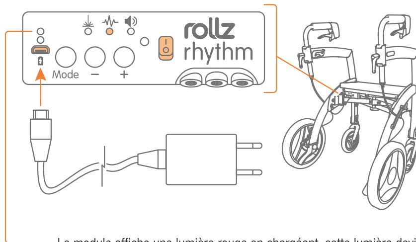
Le module affiche une lumière rouge en chargeant, cette lumière devient vert lorsque la charge est complète. Ne chargez le module qu'avec un chargeur de 5V et 1A.
