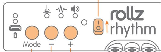
Verwenden Sie die Tasten “-” und “+”, um die Lauffrequenz zu erhöhen oder zu verringern: Es geht um die Schritte pro Minute. Für eine Erhöhung der Gehgeschwindigkeit wählen Sie “+”. Für eine Verringerung der Gehgeschwindigkeit wählen Sie “-”.
