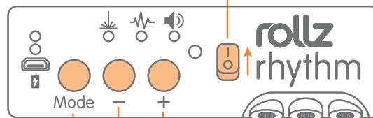
Gebruik de “-“ en “+“ knoppen om de loopfrequentie te vergroten of te verkleinen: het gaat om stappen per minuut. Voor een verhoging in loopsnelheid, kies “+“. Voor een vertraging in loopsnelheid, kies “-“.
