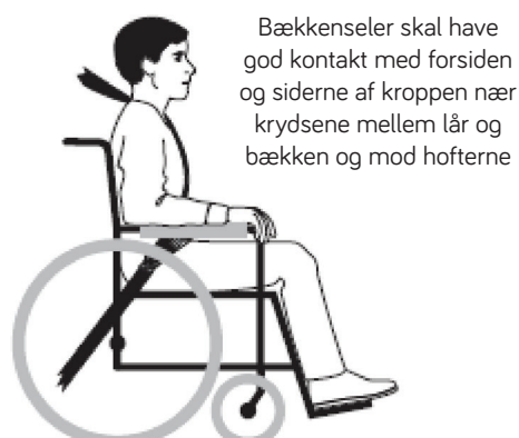
Figur 3b – Korrekt føring og positionering af seler på kørestolspassageren.
