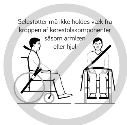
Figur 3a – Forkert positionering af bækkenseler over kørestolsstøtter.
