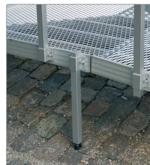
Benene kan forskydes/ vinkles i holderen og justeres med fingerskrue i foden
