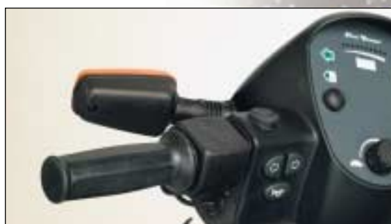
5. Drejegasregulering, højre. (Varenr. T-127-06-110). Drejegasregulering, venstre. (Varenr. T-127-06-111).
