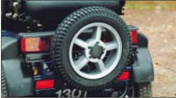
36. Reserverhjulsholder, bagmontering. (Varenr. T-127-06-138).
