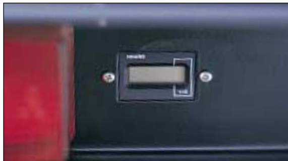
23. Timetæller. (Varenr. T-127-06-155). (HMI 30069).
