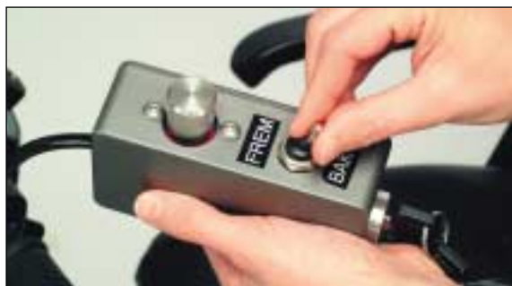
1. Fjernbetjening for Mini Crosser. Frem/bak og hastighedsregulering. (Varenr. T-127-06-113).
