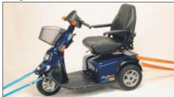
13. Selesæt til fastspænding af køretøj. Længde 35-68 cm. Brudstyrke 25000 N/sele. (Varenr. T-127-06-146).
