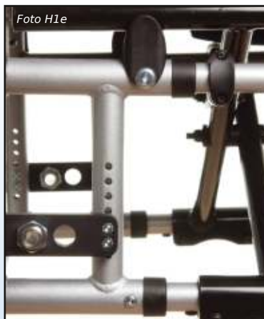
Siddedybde justerbar samt indstilling af hjul position
