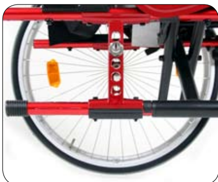
Justerbar sædedybde fra 41 til 51 cm. Op til 7,5 cm drivhjuls-tyngdepunktsjustering muliggør nem drejning og bedre ydeevne (standard)
