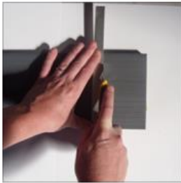
Tilskæring af lav rampe
