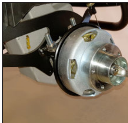
Afmontér afdækningen. (17 nøgle)
