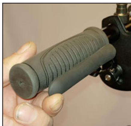
Det betyder at firefingergrebet skal helt op og røre ved håndtaget, imens den spændes fast.
