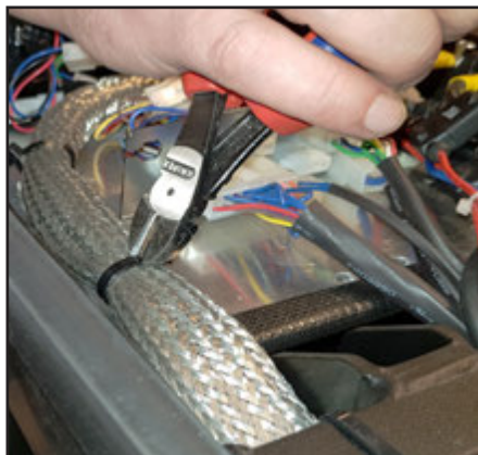
Klip stripsene der holder kablet på plads. Nye sættes på ved montering.
