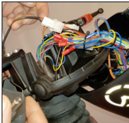
Klips stikket fra. Potentiometeret er nu fri.
