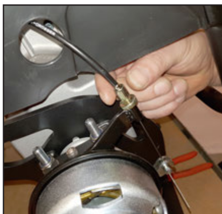
Finindstillingen af bremsen sker med justeringskruen.
