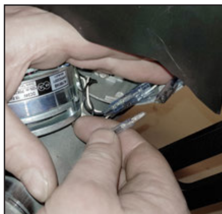
Afmonter de fire stik, og magnetbremsen er fri.
