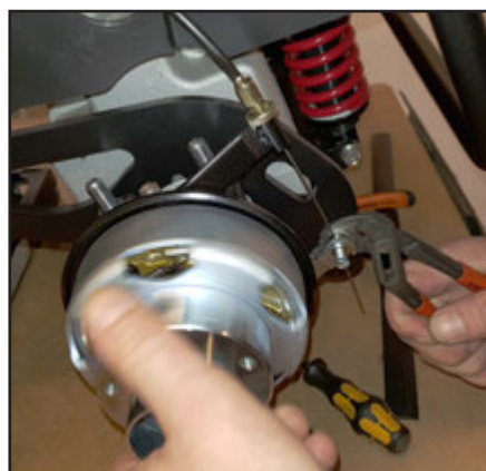
Og igennem huller. Imens der bremses ved at løfte op med tangen, og drejes på hjulnavet, indstilles bremsen. Der må ikke være lyd fra hjulnavet. Når der kan drejes lige præcis uden lyd, spændes bremsekablet.
