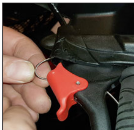
Skub kablet hele vejen igennem det eksisterende yderkabel, til det kommer ud ved baghjulet.
