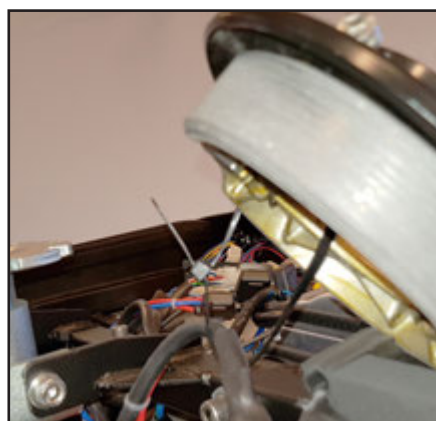
Brug evt. et langt kabelstips til at holde den på afstand af arbejdsstedet.
