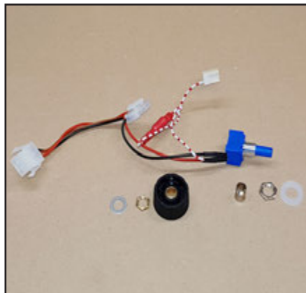
En ny drejepotentionmeter. Monteres i modsat rækkefølge.
