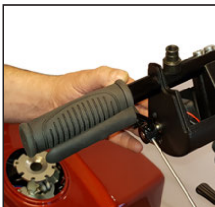
Bemærk - når wigwag gashåndtaget monteres igen, skal den skrues fast i stillingen "Fuld gas".
