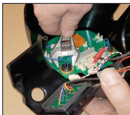
Afmontér de to møtrikker der holder printet. Bemærk at de også holder knapperne til lys og advarselslys.
