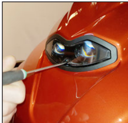
Lygten kan justeres op/ned ved at skrue på denne skrue.
