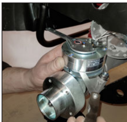
Kontroller afstanden til magneten. Hvis den er større end 0,35 mm, er den slidt for meget og skal skiftes. En ny har en afstand på 0,15 mm.
