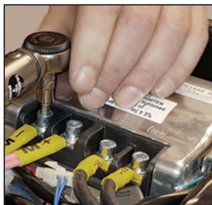
De øvrige stik monteres. Spændes med 5 Nm.
