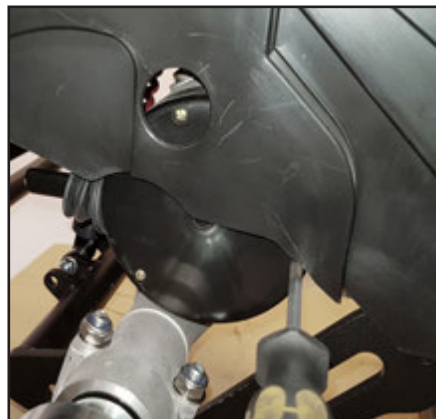
Afmonter kappen. 3 skruer.
