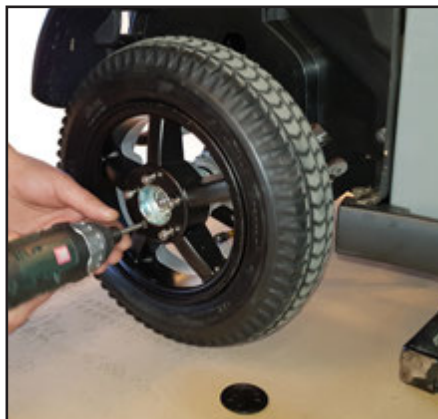
Hæv bagenden af scooteren så baghulet er fri af undelaget.
