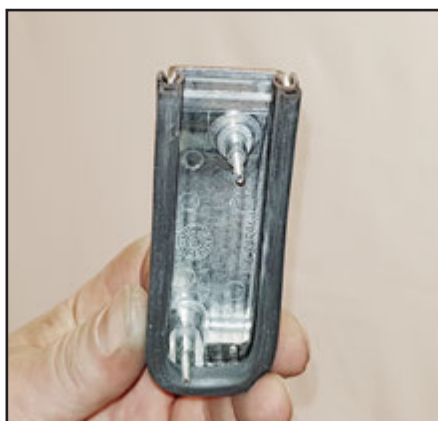
Når afdækningen skal monteres igen, skal man undgå at klemme kablerne.
