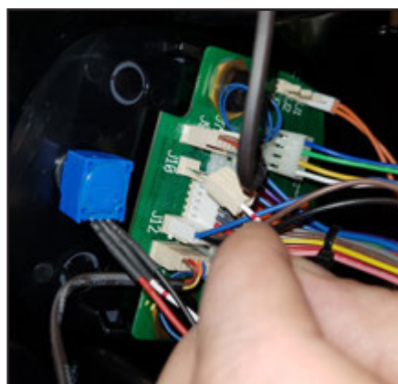
Afmontér de forbundne stik i printpladen. Alle stik er nummereret. Følg skemaet på indersiden af hovedet ved genmontage af hovedet.
