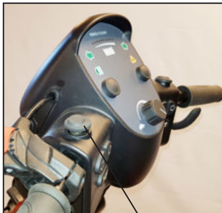
Start med at afmontere propperne, eller sidespejlene, hvis de er monteret.
