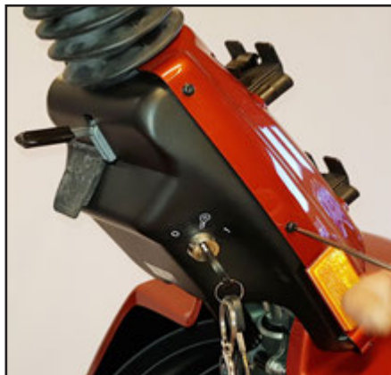
Afmontér de seks skruer der holder skærmen.
