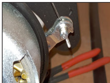
Bremsekablet afkortes, og kabelafslutningen klemmes på. Kontrollér at funktionen virker korrekt.
