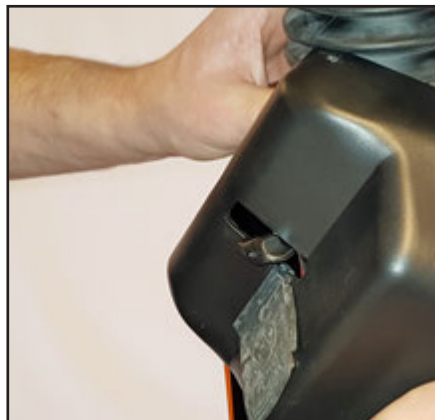
Når skærmen er løs, drejes den næsten 90°, så den kan trækkes ud over håndtaget. Skærmen er stadig fastgjort via et kabel, men nu er der adgang til gasdæmperen.
