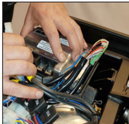
Styringen er nu fri. En evt. ny monteres på samme plads. Montér alle stikkene igen.
