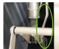
5. OBS! Påsæt lænkeled korrekt ved aktuator til lårdel.
