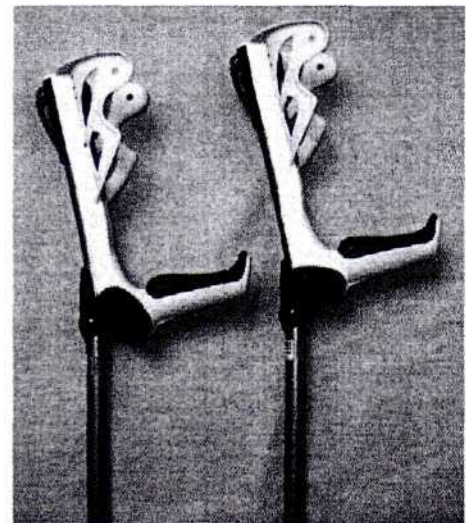
Photos n°5 et 6 : comparaison de la poignée avant et après essai de fatigue. Sur l'échantillon de gauche ayant subi l'essai, l'amortisseur est détruit entraînant une position plus basse.
